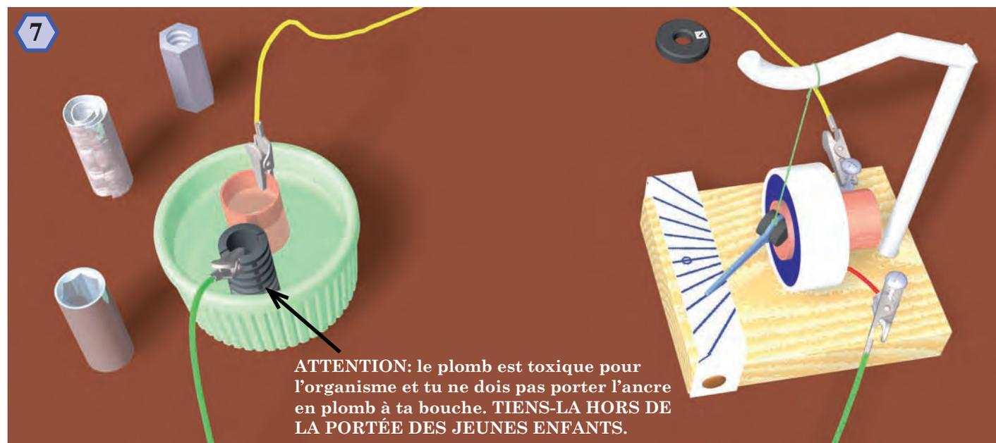
Avec ton galvanomètre, vérifie l'efficacité de différents couples de métaux pour générer de l'électricité dans une pile.
