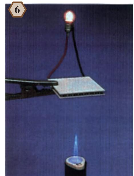
*Thermopile commerciale (3 cm × 3 cm), du type schématisé sur la figure 5, chauffée par un brûleur. Le courant produit alimente une ampoule électrique miniature (gracieuseté de M.G. Kanatzidis).*
