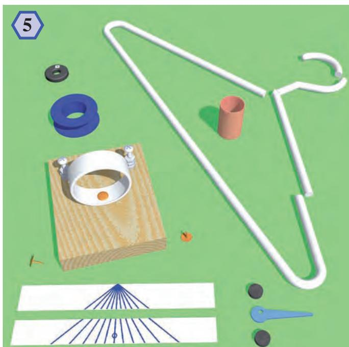
Les composants utilisés pour construire le galvanomètre.
