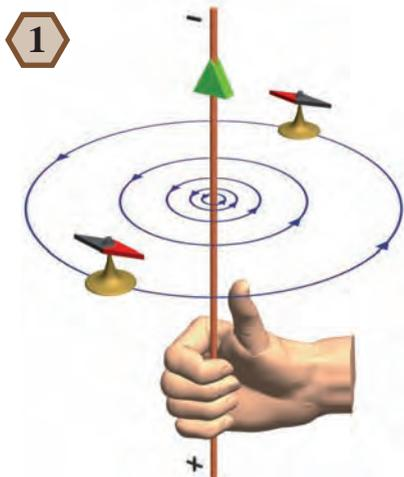
Le sens des lignes du champ magnétique (flèches bleues) produit par un courant électrique est indiqué par l'extrémité des doigts de la main droite, lorsque cette main agrippe le fil et le pouce pointe dans la direction du courant (flèche verte). Ce sens a été établi, par convention, comme le sens de la force qui s'exerce sur le pôle Nord (en rouge) d'une aiguille aimantée.
