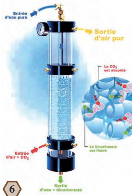
**Le bioréacteur expérimental de CO<sub>2</sub> Solution transforme le CO<sub>2</sub> en bicarbonate, un matériau solide inoffensif pour l'environnement, qu'on retrouve dans certaines roches. L'agent actif est une enzyme (gracieuseté de CO<sub>2</sub> Solution).**
