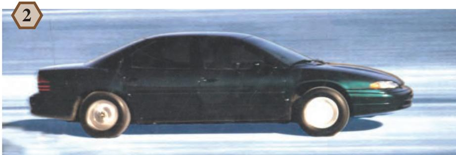
L'automobile électrique dévoilée en 1994 par Hydro-Québec. Cette Chrysler Intrepid transformée possède deux moteurs-roues à l'arrière. Le prototype de 1995 était équipé de quatre moteurs-roues (archives du journal Le Devoir, de Montréal).
